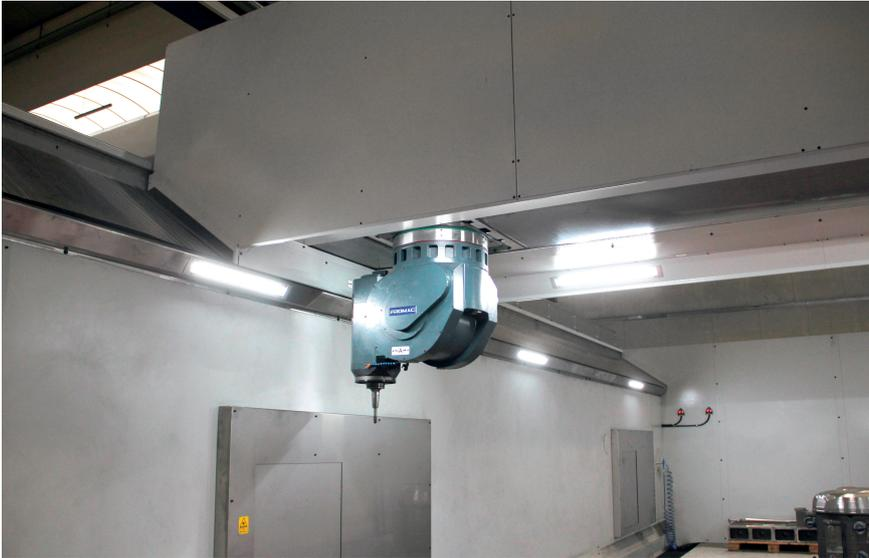
**Box-in-Box-Konzept:** Blick auf die Traverse/Querachse des Portal-BAZ, die den 2-Achs-Fräskopf trägt; diese kann bei der Sharav einen Verfahrweg von 2500 bis 4000 mm überbrücken © Promac
