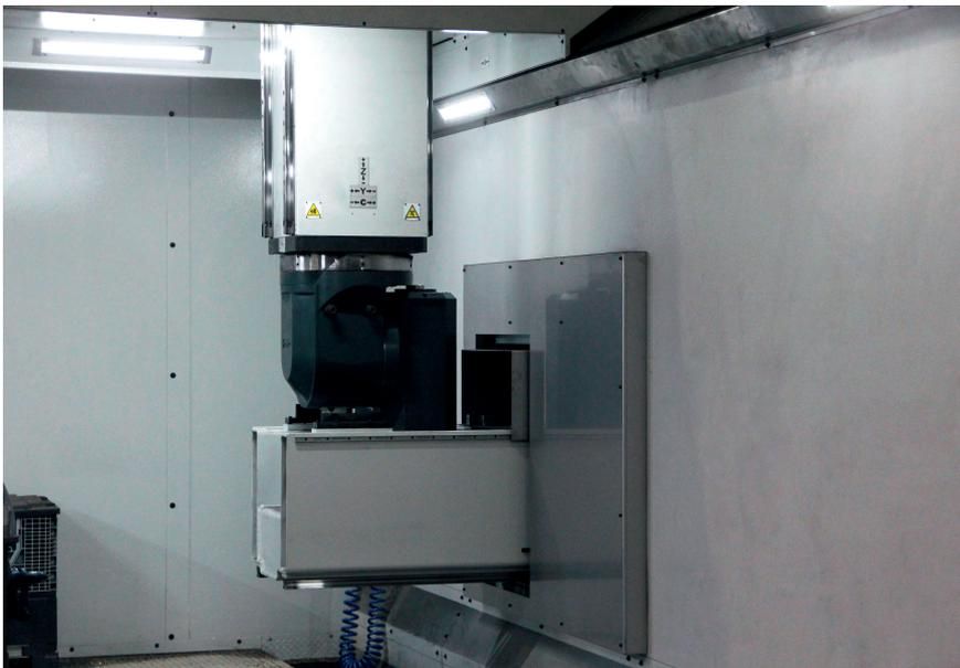
**Kopfwechselsystem:** Ein Clou des Maschinenkonzepts der Sharav HGVT ist der vollautomatisch und unbeaufsichtigt stattfindende Fräskopf-Wechsel; auf diese Weise lassen sich in einer Aufspannung Schrupp-, Vorschlicht-, Schlicht- und Bohrarbeiten bei optimalen Schnittdaten durchführen © Promac
